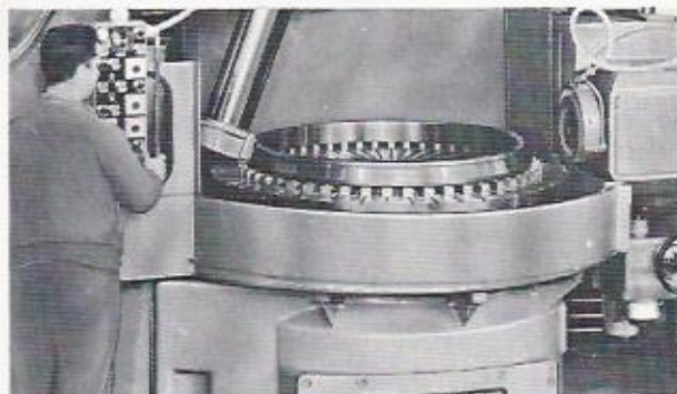
Usinage d'une bague de butée sur mandrin type ERC équipant une rectifieuse Berthiez.
